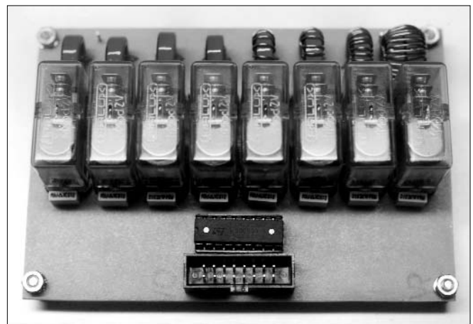
Foto B. La placa del banco de inductancias totalmente montada a punto para su instalación. Todo lo que queda es sujetarla en la caja y enchufarla mediante un conector.
