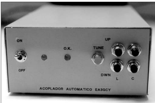
Foto A. Aspecto frontal del prototipo. La rotulación está hecha con «dymo», aunque el montaje bien merece un trabajo de serigrafía más perfeccionado. No obstante, tiene todas las indicaciones necesarias para que su manejo sea perfectamente inteligible.
